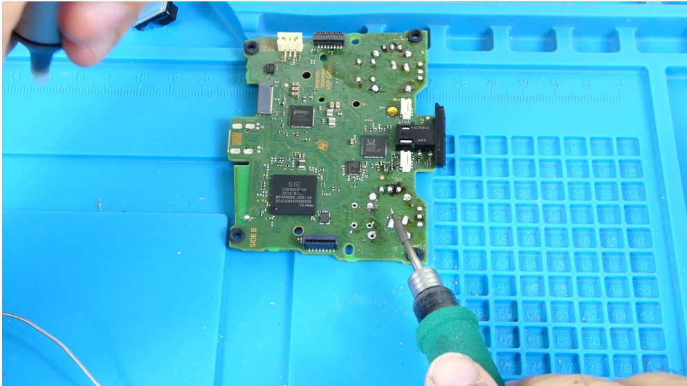
Foto real de nuestro taller — la placa base de un DualSense: chips SMD de distinto tamaño, un conector de pines densos y zonas THT, todo a centímetros de distancia.
