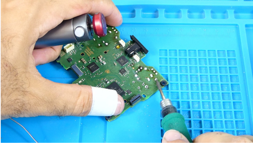
Foto real de nuestro taller — la técnica a dos manos: soldador fundiendo el pin mientras la bomba de succión espera lista para vaciar el agujero en el mismo instante.
