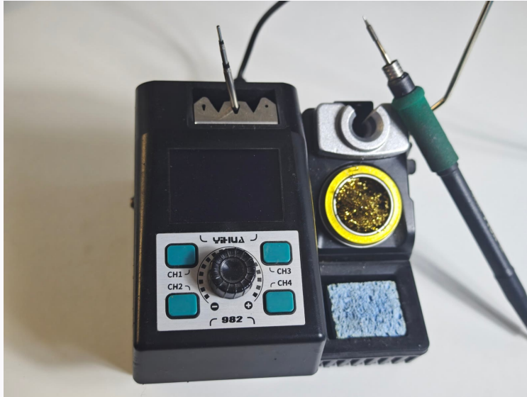
Foto real — nuestra propia estación con control PID de temperatura, la base de todo perfil térmico.
