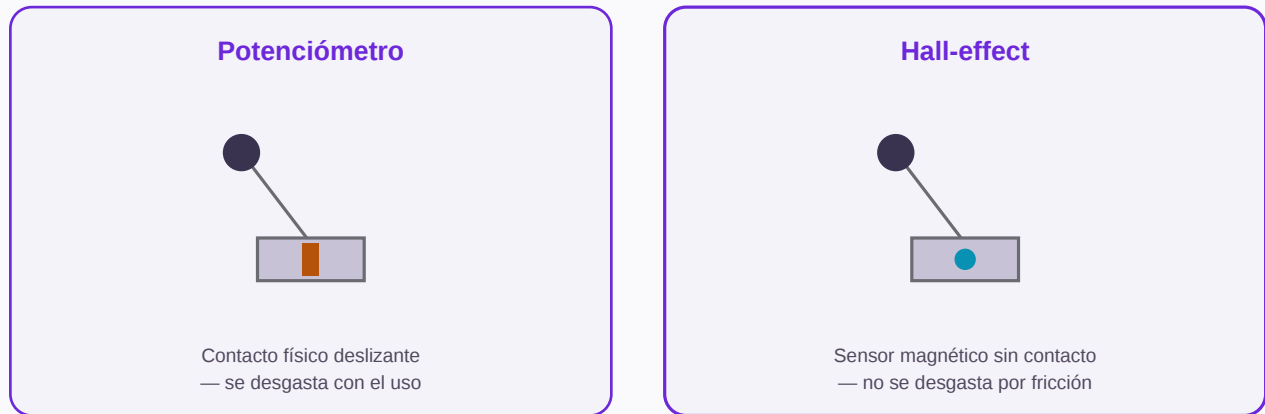
Diagrama 1.1 — comparación esquemática (ilustración propia) entre las dos tecnologías de stick más comunes.
