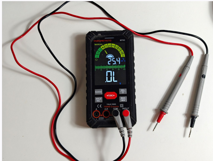
Fig. 3.1 — El multímetro en modo continuidad ayuda a descartar una soldadura defectuosa (tipo 7) sin necesidad de desoldar nada.
