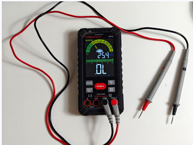
Fig. 4.3 — Multímetro digital midiendo continuidad con sus dos puntas de prueba.
