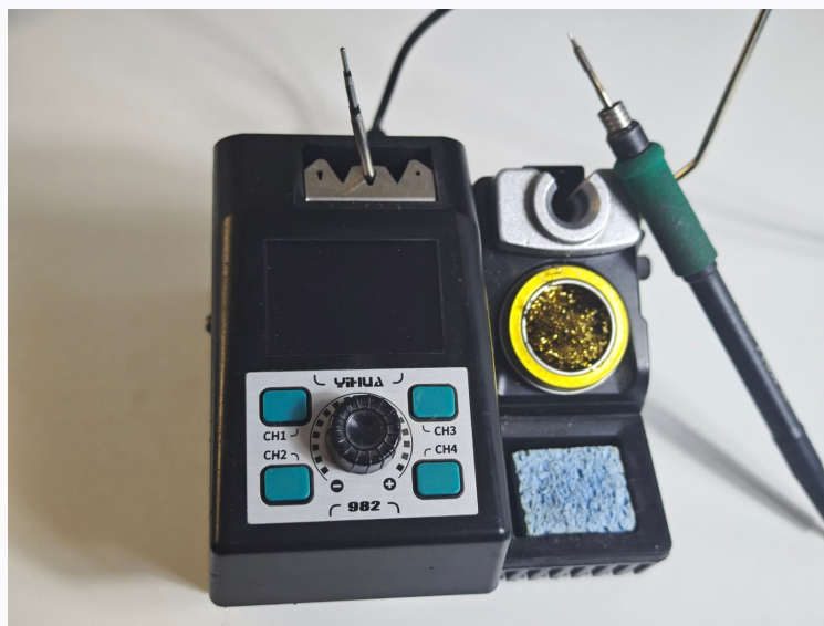
Fig. 2.1 — Estación con display digital y control de temperatura, soporte para el soldador, bola de virutas de latón y esponja húmeda integrados — el montaje estándar de nuestro banco de trabajo.
