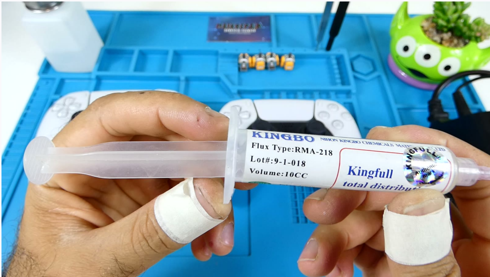
Fig. 2.4 — Jeringuilla de flux en gel: una gota pequeña sobre el pad antes de soldar marca una diferencia notable en juntas SMD pequeñas.
