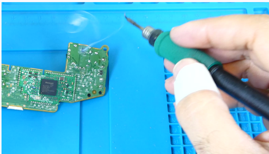
Fig. 1.1 — El humo del flux sube en línea recta desde la punta caliente: colócate siempre para que no te llegue directamente a la cara.
