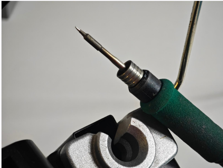
Fig. 2.2 — Punta cónica fina en buen estado: superficie plateada, brillante y limpia. Una punta oxidada se ve gris/negra y ya no transfiere calor bien (ver Capítulo 3).
