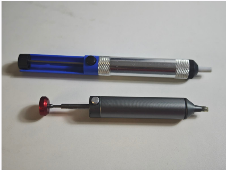
Fig. 2.5 — Bombas de succión (desoldadores de émbolo): retiran el estaño fundido por vacío en el momento. Ver técnica completa en el Capítulo 8.
