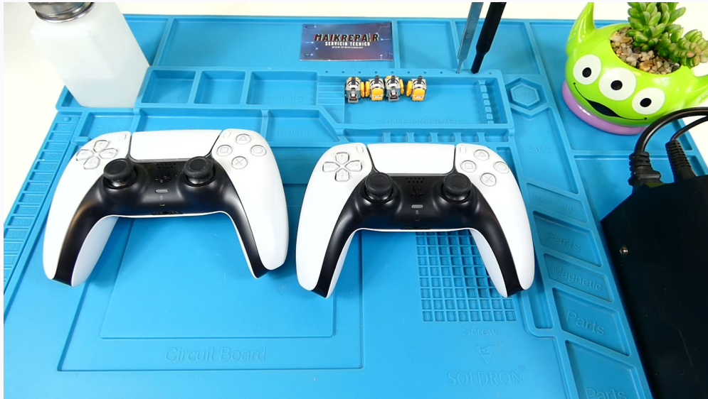
Fig. 2.6 — Kit real de trabajo: mandos de prueba, módulos de repuesto, destornillador de precisión y pinzas sobre esterilla antiestática.
