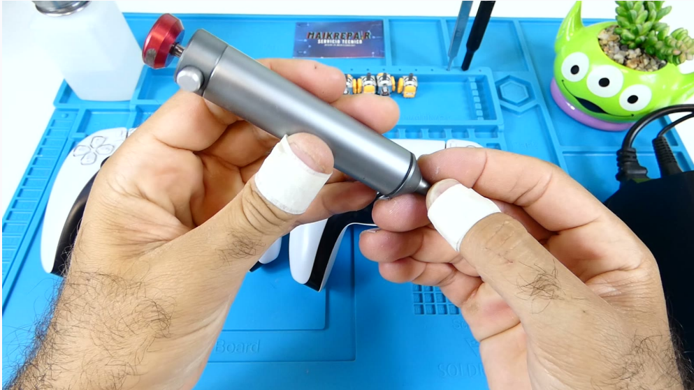
Fig. 8.1 — Soldador con dial de temperatura y bomba de succión, el combo habitual para retirar componentes con pocos pines.
