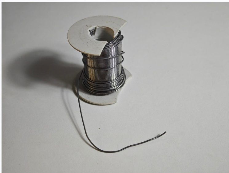
Fig. 2.3 — Bobina de estaño con núcleo de flux. Guarda siempre el hilo en un sitio seco: la humedad degrada el flux interno con el tiempo.
